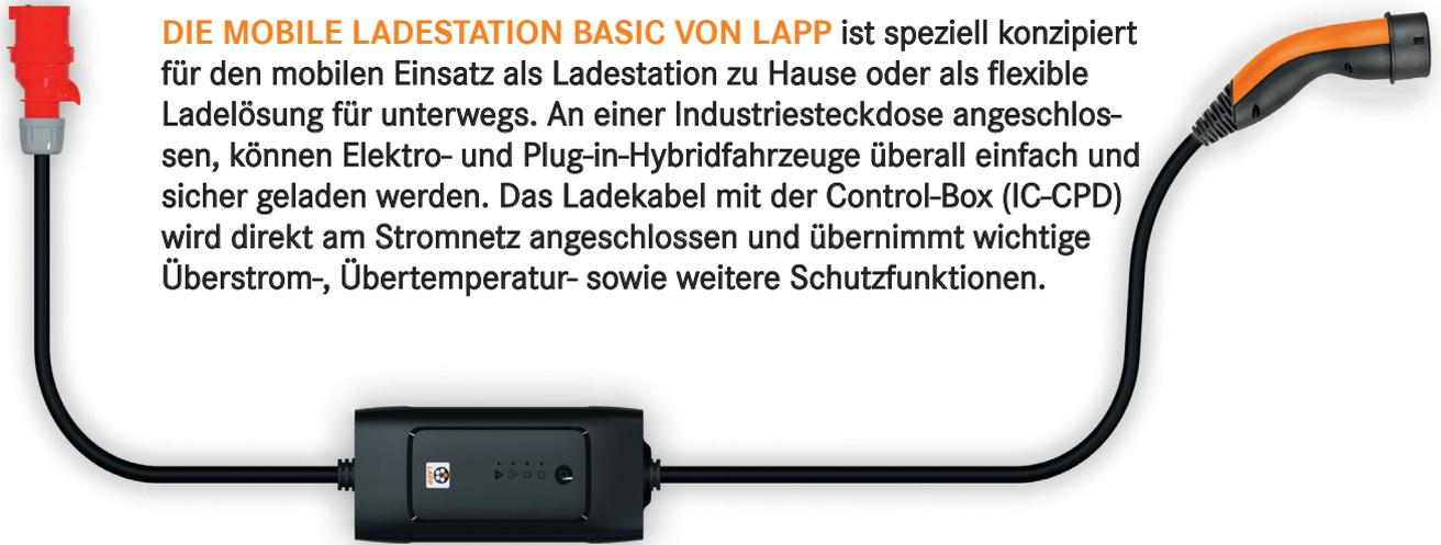
**DIE MOBILE LADESTATION BASIC VON LAPP** ist speziell konzipiert für den mobilen Einsatz als Ladestation zu Hause oder als flexible Ladelösung für unterwegs. An einer Industriesteckdose angeschlossen, können Elektro- und Plug-in-Hybridfahrzeuge überall einfach und sicher geladen werden. Das Ladekabel mit der Control-Box (IC-CPD) wird direkt am Stromnetz angeschlossen und übernimmt wichtige Überstrom-, Übertemperatur- sowie weitere Schutzfunktionen.
